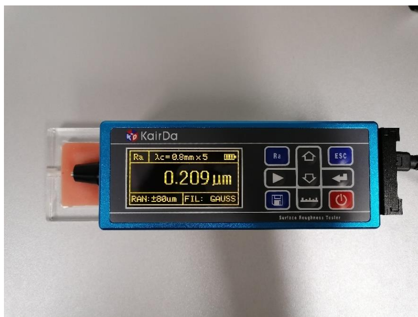
Slika 2. Surface Roughness Tester KR210 (KairDa, Kina)
