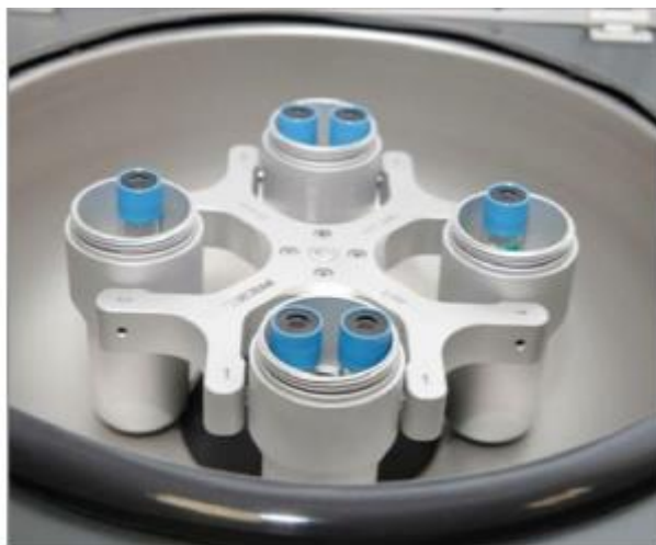
Slika 1. BTI centrifuga System IV
