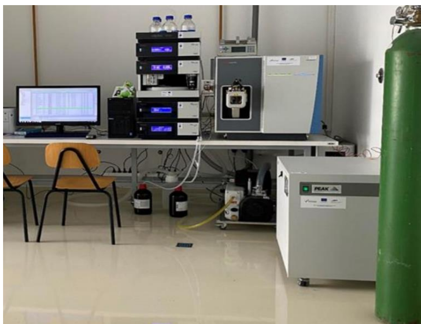
Slika 7. UHPLC-DAD-MS/MS uređaj Kemijsko-tehnološkog fakulteta u Splitu.
