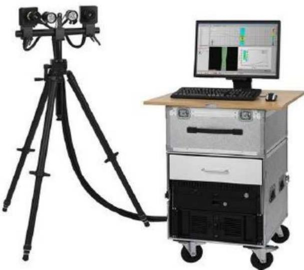
*Slika 30. Optički mjerni sustav Aramis 4M.*
