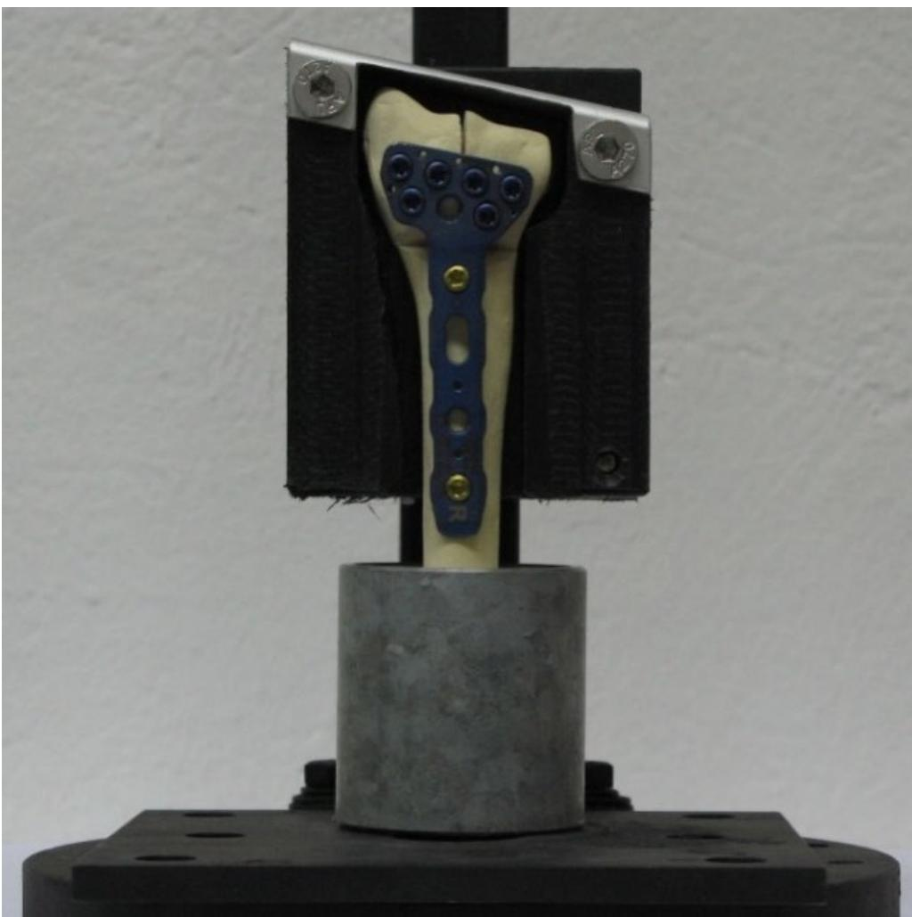
*Slika 28. Pozicioniranje modela Zrinski za zalijevanje.*
