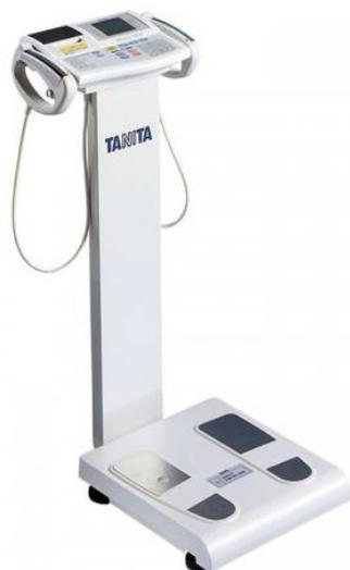
**Slika 7.** Primjer uređaja za analizu sastava tijela BIA metodom. Dostupno na <https://valhallawellness.com/conditions/bioelectrical-impedance/> (pristupljeno u rujnu 2021).
