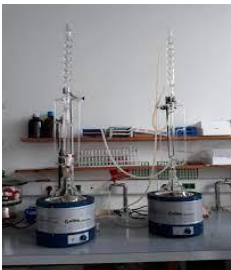
Slika 9. Hidrodestilacija u aparaturi po Clevengeru
