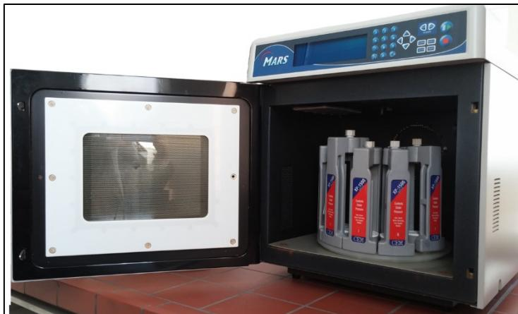
Slika 3. Mikrovalna peć za digestiju uzoraka CEM Mars 5
