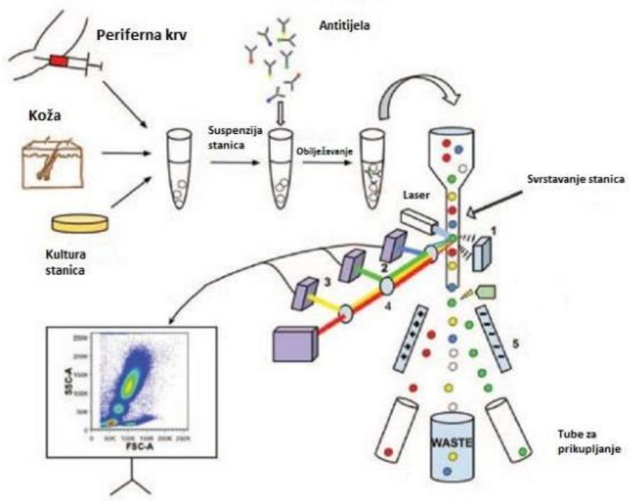
**Slika 3.** Princip rada protočnog citometra (37)
