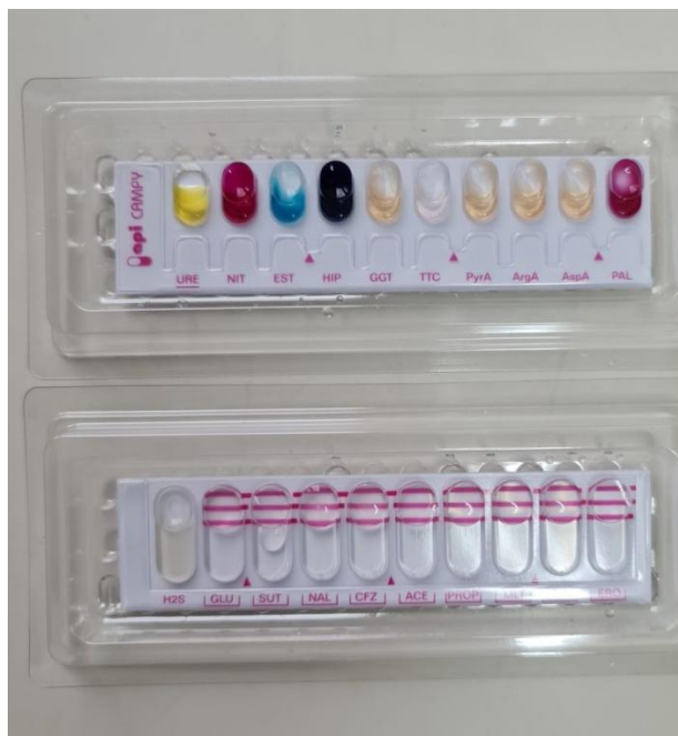
Slika 5. Prikaz „apiCampy“ niza nakon dodatka suspendirane kulture Campylobacter (fotografirano u zgradi NZJZ SDŽ u Splitu, 25. Studenoga 2021.)
