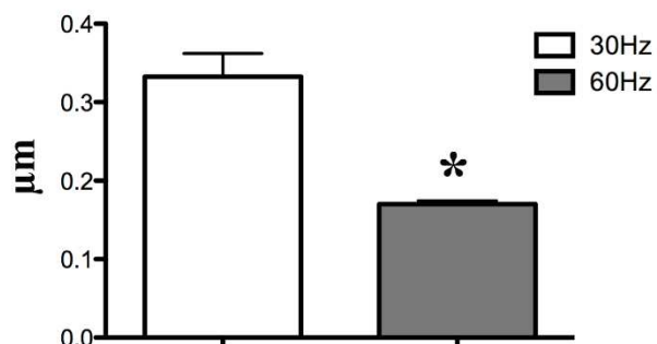
Slika 21. Grafički prikaz putovanja elektrode kod primjene vibracijskih podražaja od 30 Hz i 60Hz. Statistički značajno manje putovanje elektrode (od eng. displacement) zabilježeno je kod frekvencija od 60Hz (nesparen t-test, n=6, p<0,0001). Svaki stupac predstavlja srednju vrijednost za određenu frekvenciju uz standardnu devijaciju.
