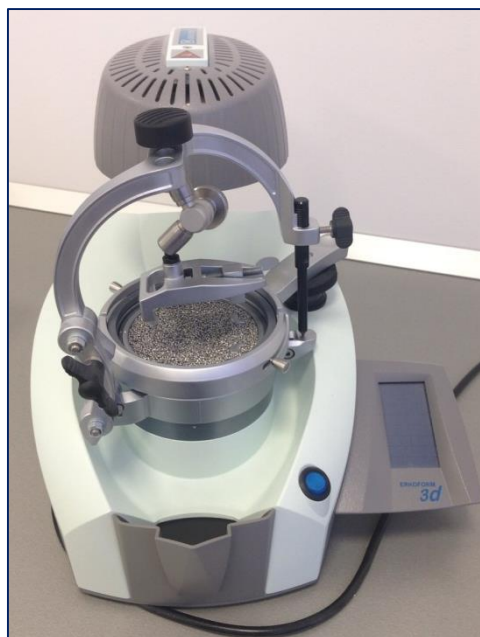
Slika 14. Uređaj za termo-oblikovanje folija s integriranim vakuumom ( Erkoform-3D Occluform, Erkodent, Pfalzgrafeweiler, Njemačka ).
