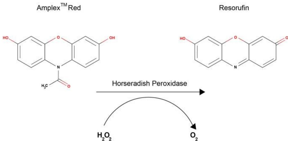
**Slika 12.** Interakcija Amplex Red indikatora s vodikovim peroksidom. (izvor: Karakuzu O, Cruz MR, Liu Y, Garsin DA. Amplex Red Assay for Measuring Hydrogen Peroxide Production from *Caenorhabditis elegans*. Bio Protoc. 2019;9:e3409.)
