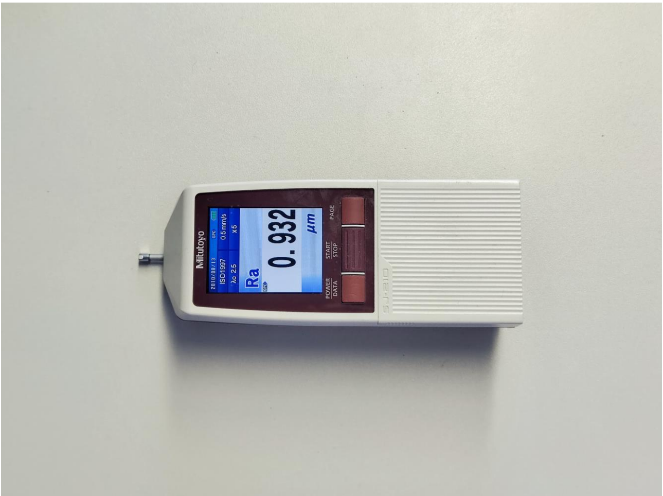
Slika 14. Prenosivi profilometar SurfTest SJ-210
