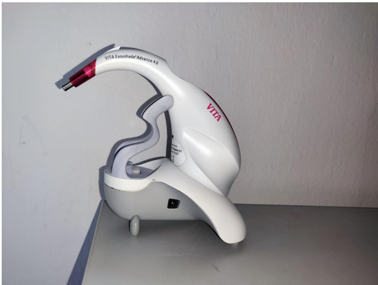
Slika 15. Spektrofotometar Vita Easyshade III
