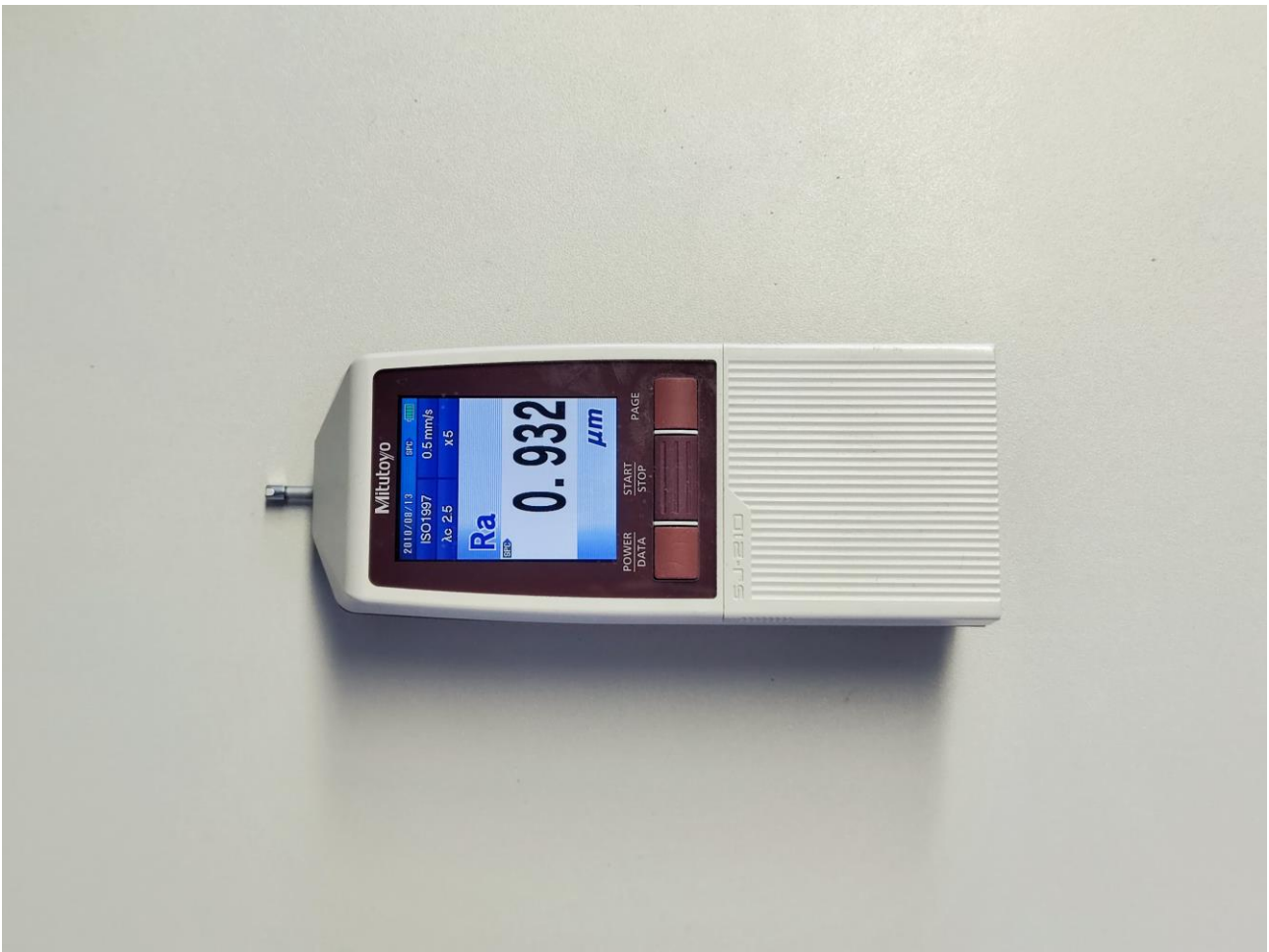
Slika 14. Prenosivi profilometar SurfTest SJ-210
