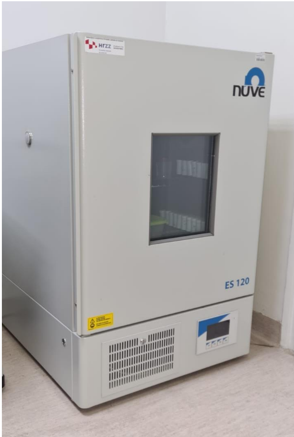
Slika 9. Inkubator za pohranu uzoraka
