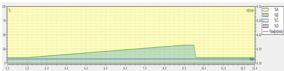
Slika 4.9. Grafički prikaz protoka mobilne faze u gradijentnom načinu eluiranja
