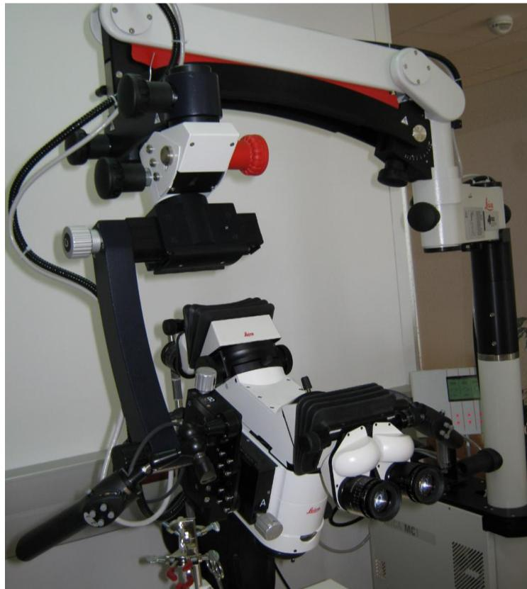
Slika 3. Neurokirurški mikroskop Leica M520 MC1
