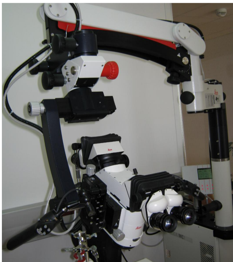
Slika 3. Neurokirurški mikroskop Leica M520 MC1
