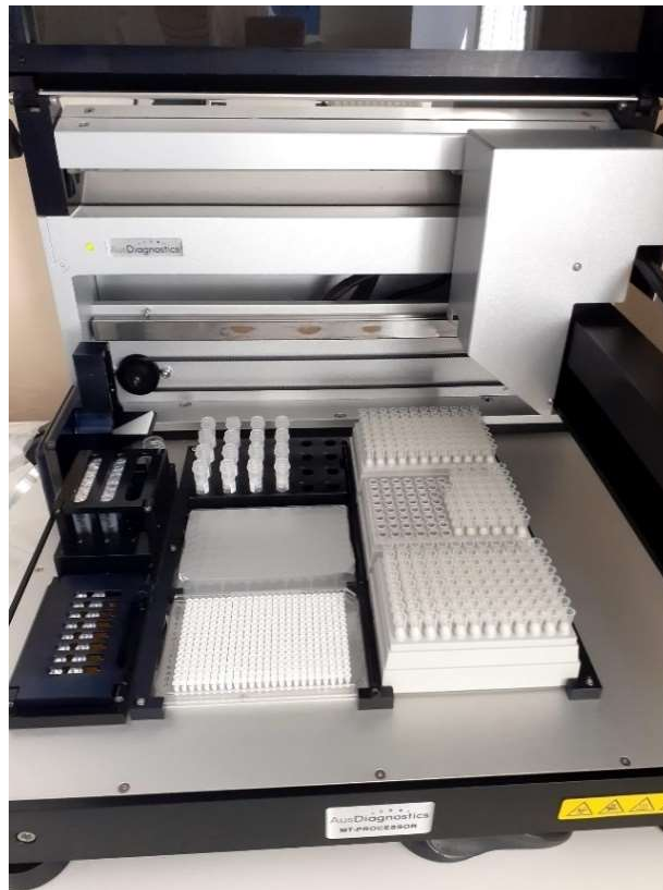
Slika 8. Uređaj AusDiagnostics MT – PROCESSOR napunjen izolatima iz uzoraka pozitivnih na M. genitalium i pripremljen za testiranje osjetljivosti na makrolide i kinolone
