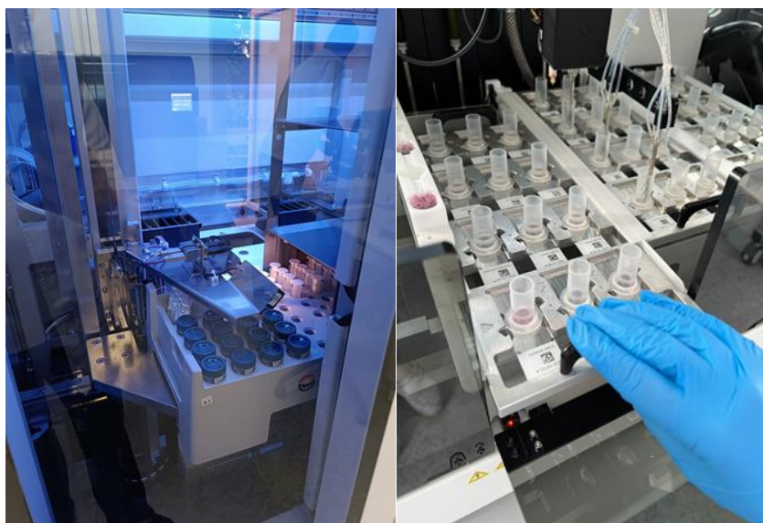
Slika 9. Automatizirana obrada uzoraka u multiprocesoru i priprema uzoraka za bojenje u SlidePrep uređaju (izvor: Klinički zavod za patologiju, sudsku medicinu i citologiju, Odjel za kliničku citologiju, KBC Split )
