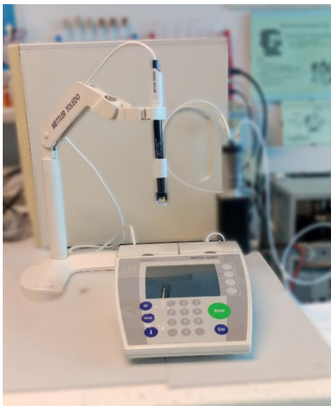
Slika 18. Milivoltmetar Mettler Toledo SevenMulti u analitičkom laboratoriju.
