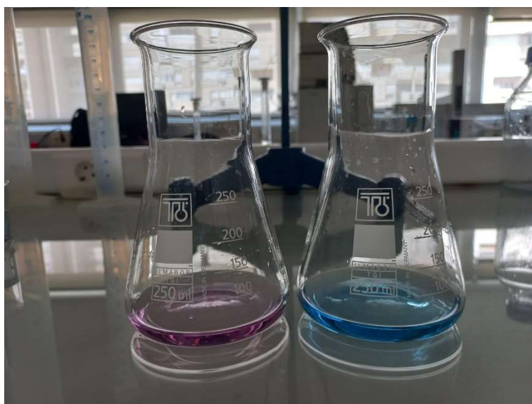
Slika 8. Boja otopine prije početka titracije (lijevo) i nakon promjene boje u završnoj točki titracije (desno)
