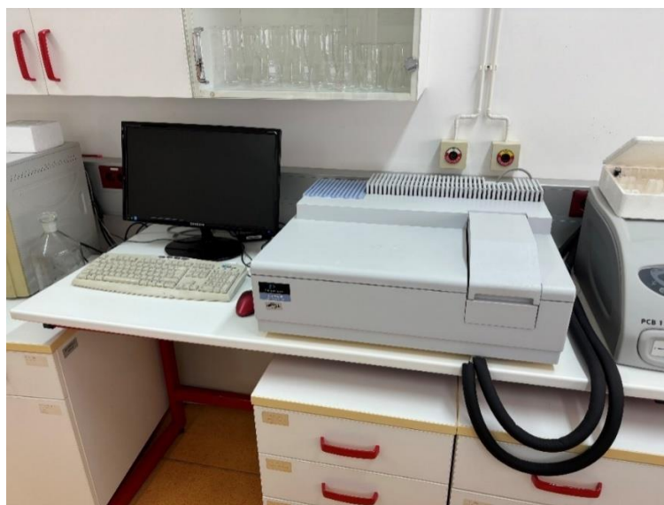
Slika 6. UV-Vis spektrofotometar (Lambda 25, PerkinElmer).
