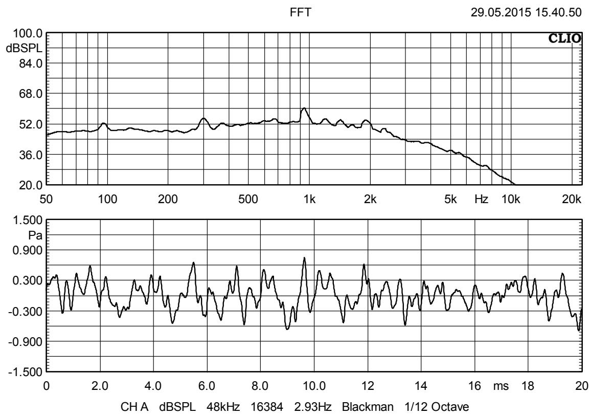
Iz grafa 1.4. (konstantna buka) možemo iščitati frekventni raspon od 50 Hz do 2 kHz.
