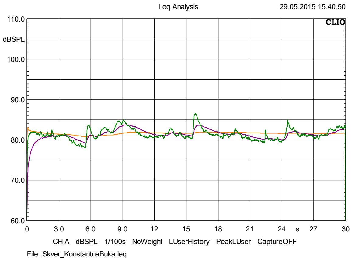
Iz grafa 1.3. (konstantna buka) možemo očitati da je preciznost mjerjenja 1/100 s u rasponu od 8 sekunda. Intenzitet buke se kreće u rasponu između 80 i 95 dB te je prilično konstantan.
