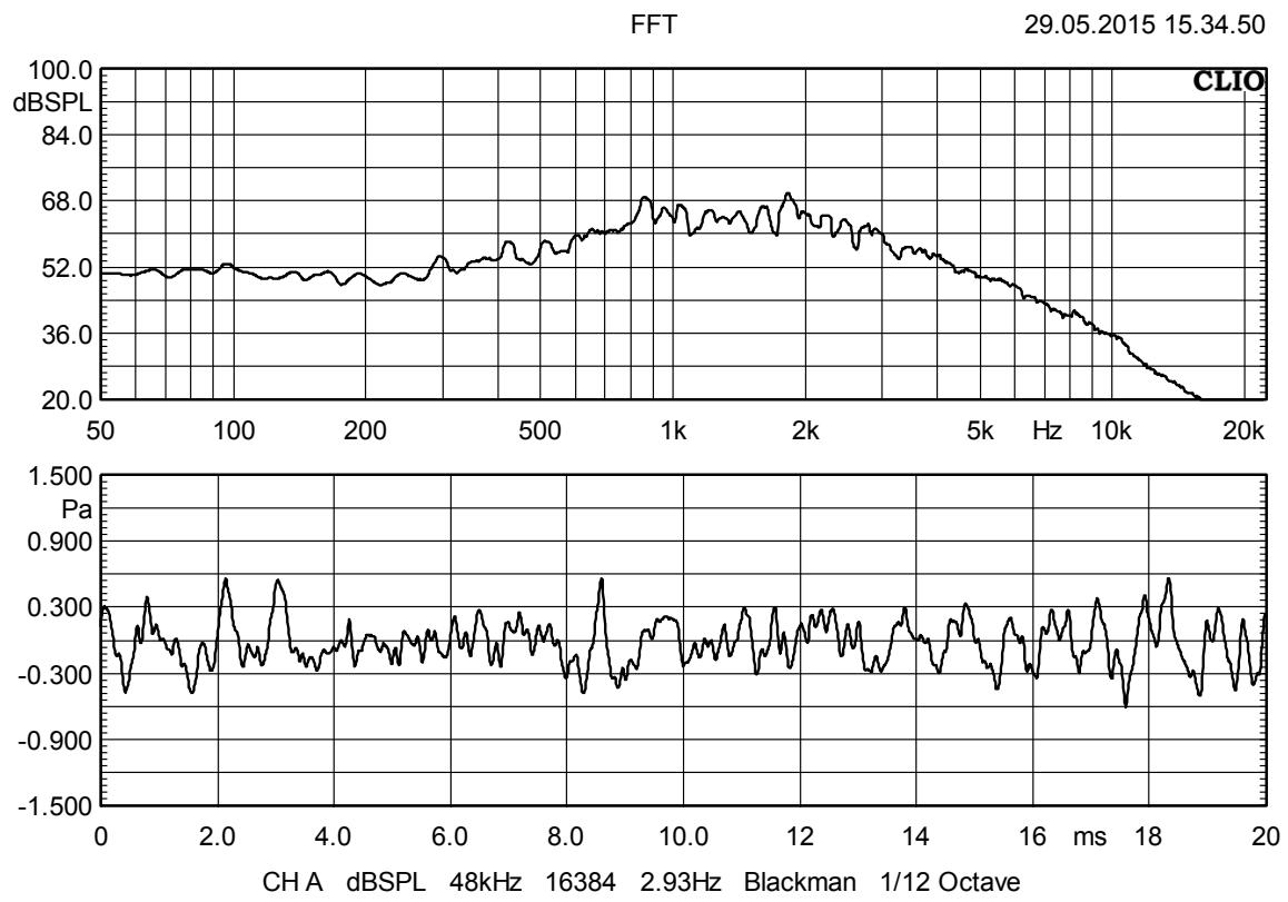
Iz grafa 1.2. (lupanje čekića) možemo iščitati frekventni raspon od 50 Hz do 2 kHz uz maksimum na 1 do 2 kHz
