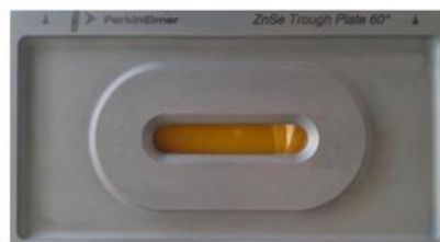
Slika 20. ZnSe kristal za praškaste i kapljevite uzorke
