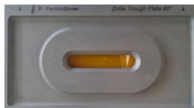
Slika 20. ZnSe kristal za praškaste i kapljevite uzorke
