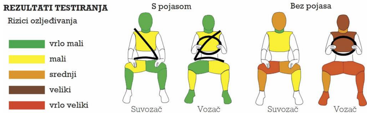
Slika 2. Shematski prikaz potencijalnih ozljeda kod vozača i suvozača sa i bez korištenja sigurnosnog pojasa.
