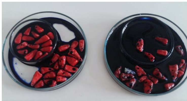
Slika 8. Prikaz uzoraka uronjenih u metilensko modrilo.
