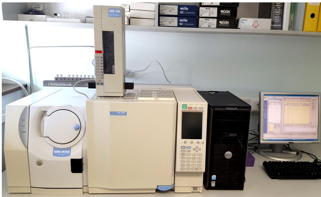
Slika 8. Plinski kromatograf sa spektrometrom masa; Shimadzu GCMS-QP2010
