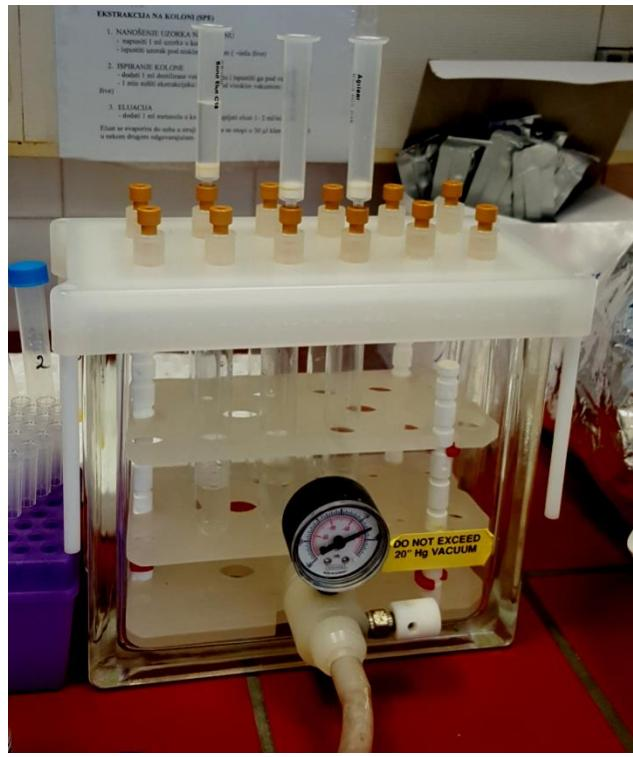
**Slika 7.** Vakuum kada za ekstrakciju s kolonama
