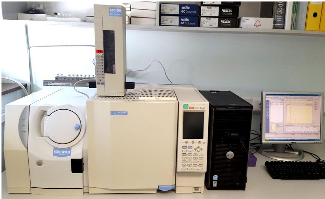
**Slika 8.** Plinski kromatograf sa spektrometrom masa; Shimadzu GCMS-QP2010
