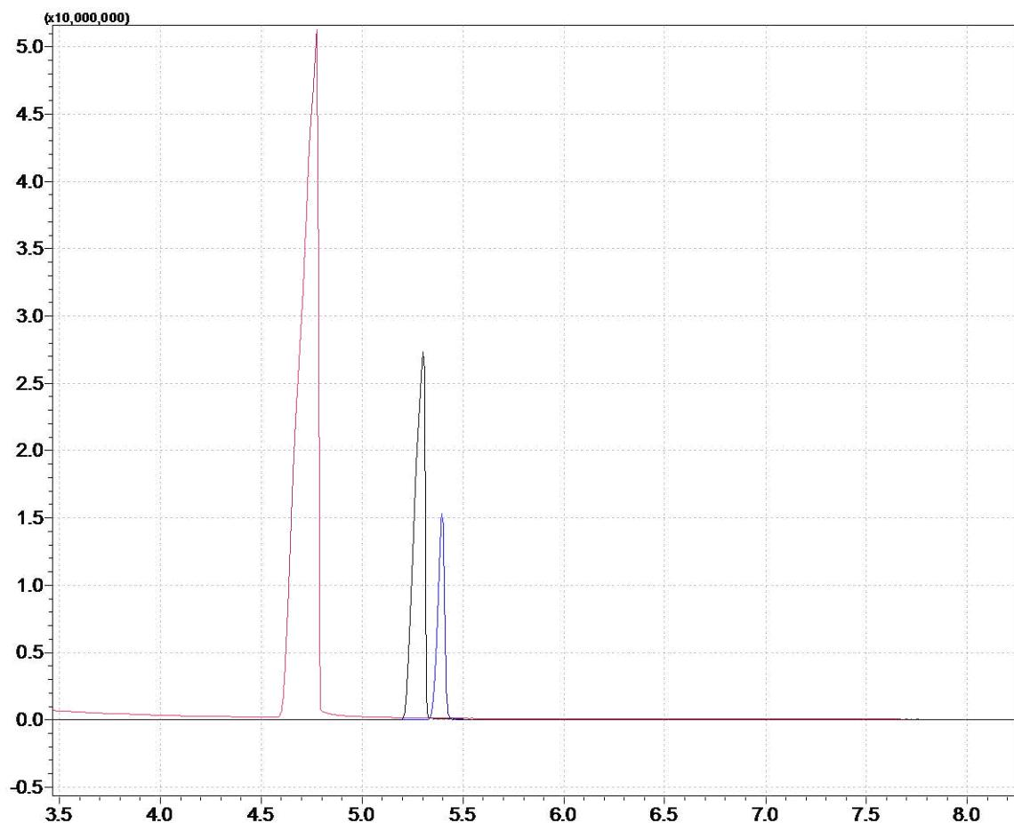
**Slika 9.** Slika prikazuje usporedbu tri postavljene metode za jednaku koncentraciju analita iz MIX-a 2 (metoda 1- crna linija, metoda 2- plava linija, metoda 3- roza linija)
