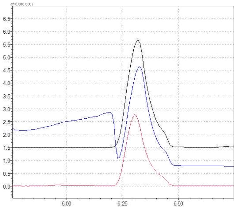
**Slika 23.** Usporedba signala identificiranih kao fenoksiethanol na kromatogramima uzoraka. crna linija - uzorak 2; plava- uzorak 6; roza - uzorak 9.
