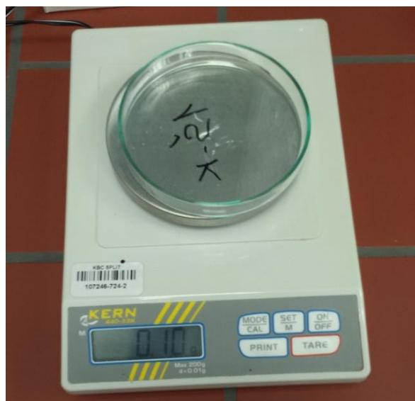
**Slika 12.** Tehnička vaga s odvaganim uzorkom (0,1 g).
