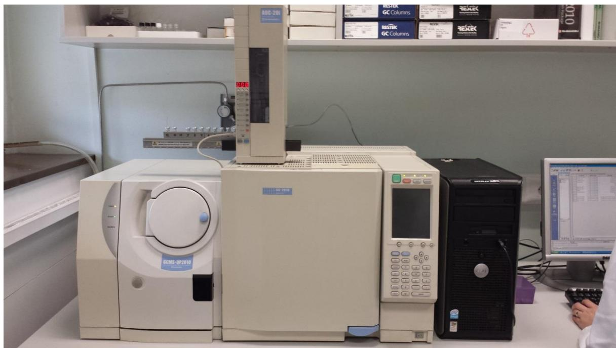
**Slika 14.** Plinski kromatograf sa spektrometrom masa, Shimadzu GCMS-QP2010.
