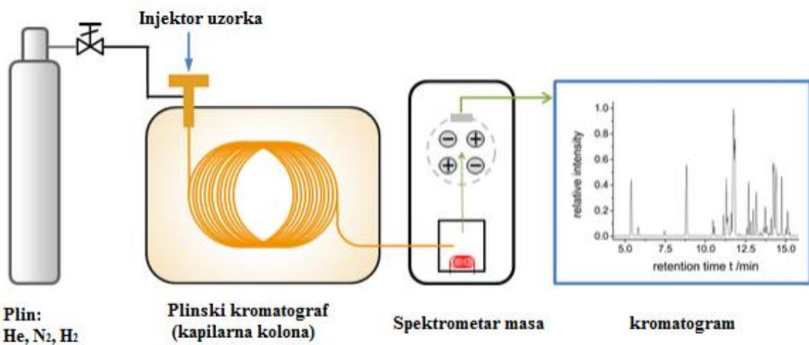
**Slika 8.** Shematski prikaz osnovnih dijelova GC-MS tehnike.
