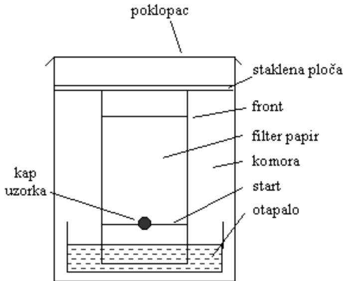
**Slika 8.** Tankoslojna kromatografija (TLC). [pristupljeno: 20.05.2018.] Dostupno na:
