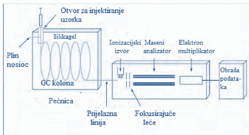
**Slika 10.** Vezana tehnika plinska kromatografija-masena spektrometrija (GC-MS).
