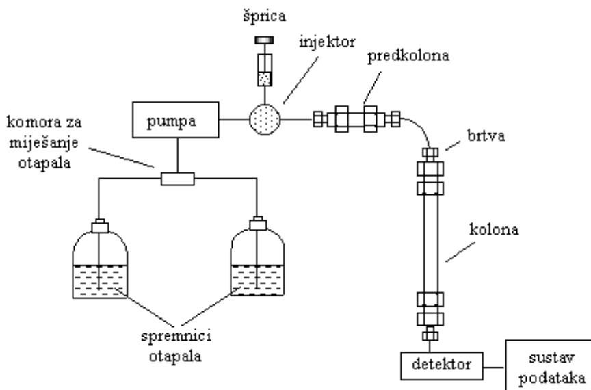
**Slika 9.** Tekućinska kromatografija visoke učinkovitosti (HPLC). [pristupljeno: 18.9.2018.]
