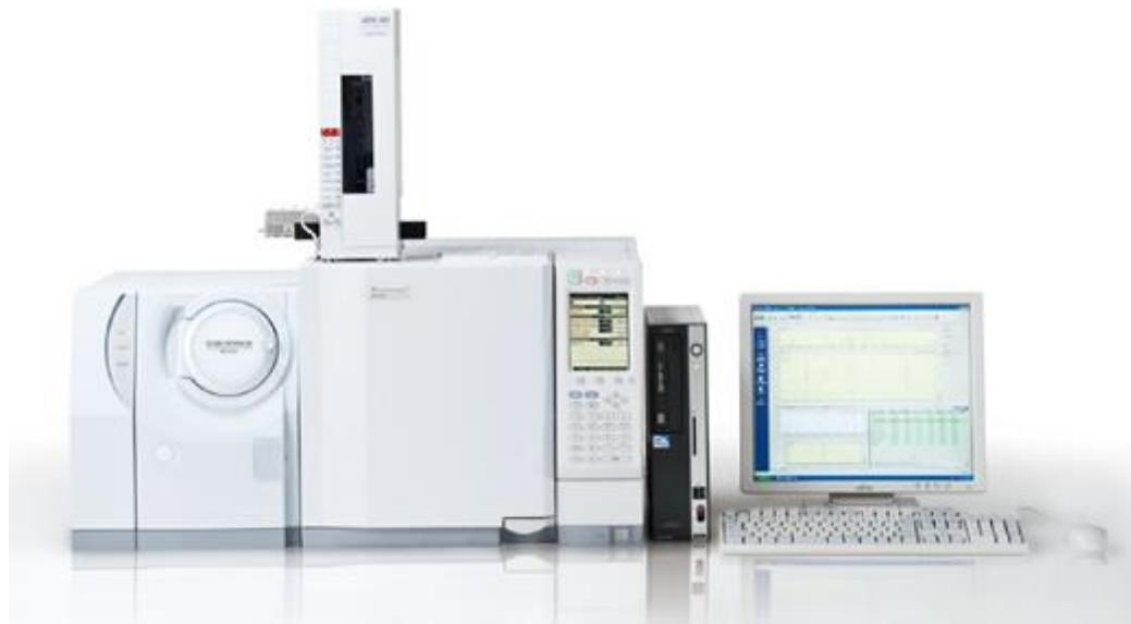
Slika 13. Plinski kromatograf sa spektrometrom masa, Shimadzu GCMS-QP2010 (65)
