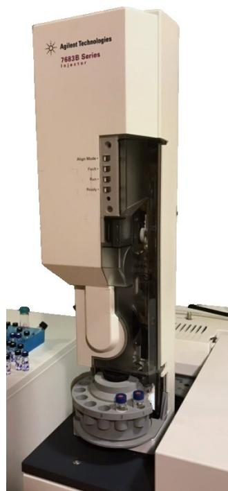
Slika 1.6. Slika korištenog automatskog uzorkivača
