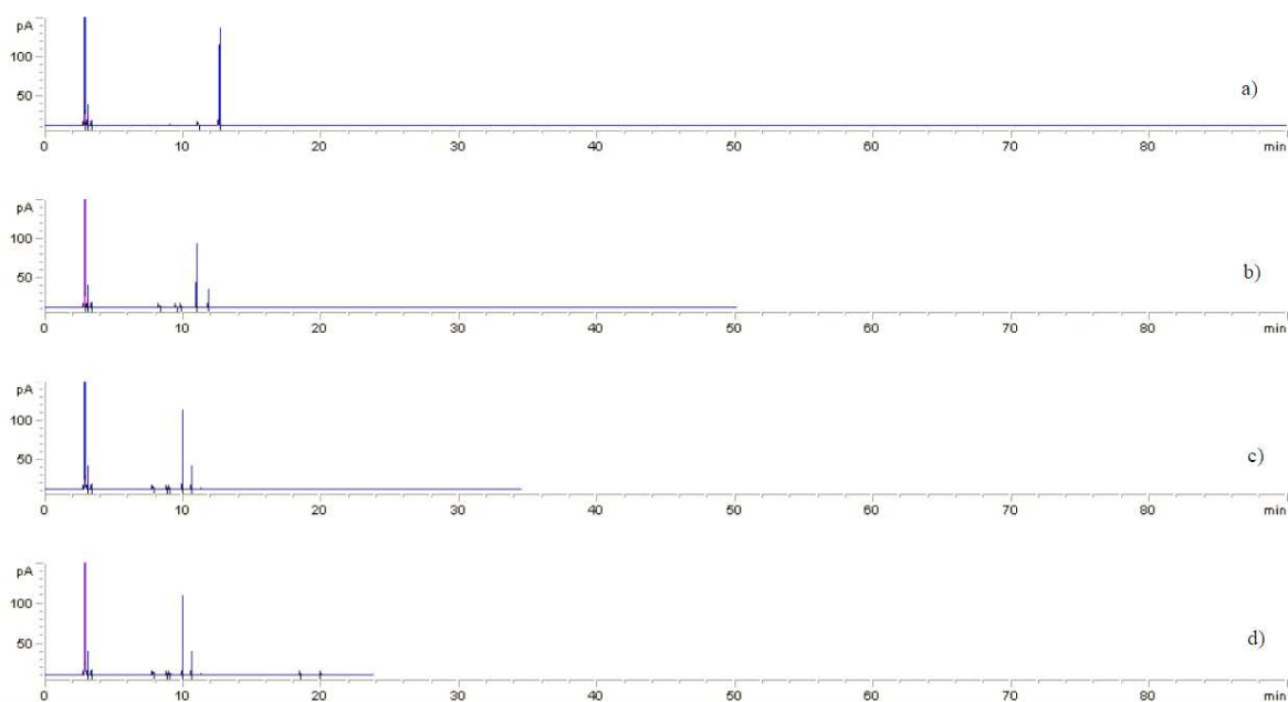
Slika 5.1. Prikaz različitog trajanja analize ovisno o korištenoj metodi na primjeru dobivenih kromatograma eteričnog ulja mandarine: a) metoda 1; b) metoda 2; c) metoda 3; d) metoda 4
