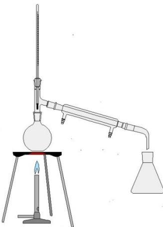
**Slika 5.** Aparatura za destilaciju.
