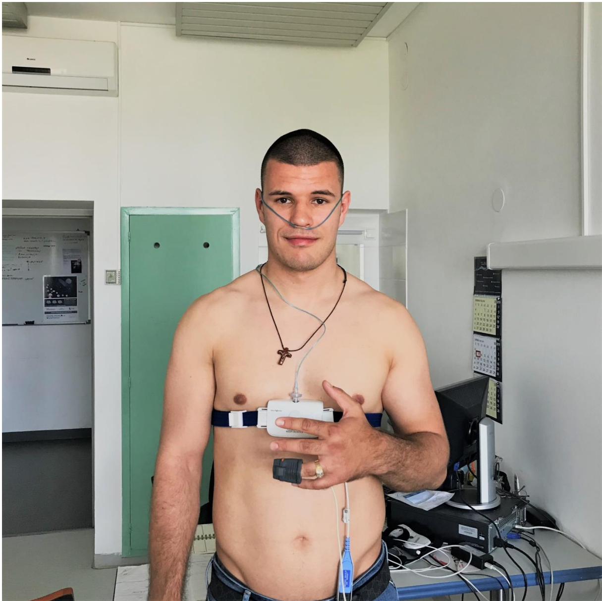
Slika 16. Prikaz postavljenog poligrafskog uređaja AliceOne na ispitaniku
