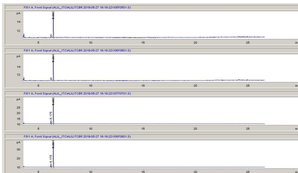
Slika 4.8. Kromatogrami standardnih otopina alil-izotiocijanata koncentracija 0,09 mg mL -1 , 0,10 mg mL -1 , 0,30 mg mL -1 i 0,50 mg mL -1 .
