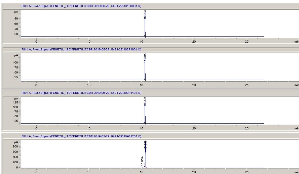
Slika 4.17. Kromatogrami standardnih otopina 2-feniletil-izotiocijanata koncentracija 0,70 \text{ mg mL}^{-1} , 0,90 \text{ mg mL}^{-1} , 1,00 \text{ mg mL}^{-1} i 10,00 \text{ mg mL}^{-1} .
