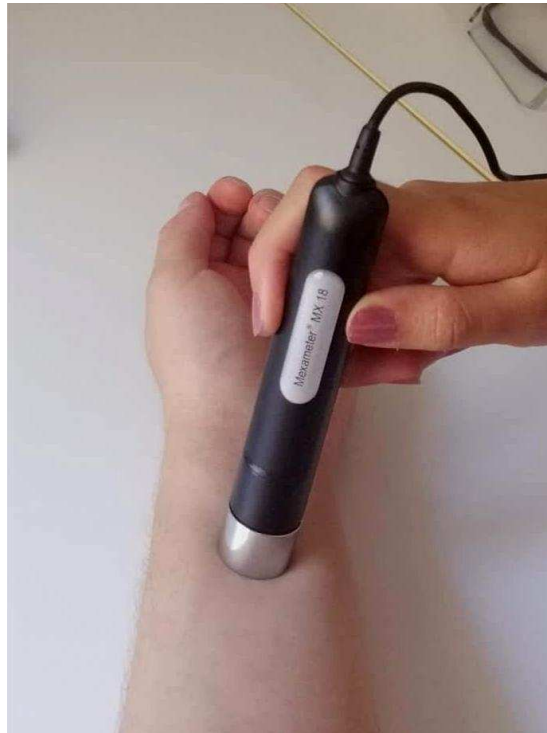
Slika 11. Mjerenje melanina i eritema pomoću sonde Mexameter
