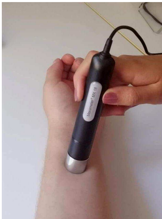
Slika 11. Mjerenje melanina i eritema pomoću sonde Mexameter
