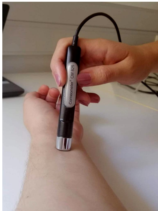
Slika 10. Mjerenje vlažnosti kože pomoću sonde Corneometer
