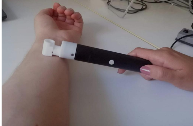
Slika 9. Mjerenje TEWL vrijednosti pomoću sonde Tewameter
