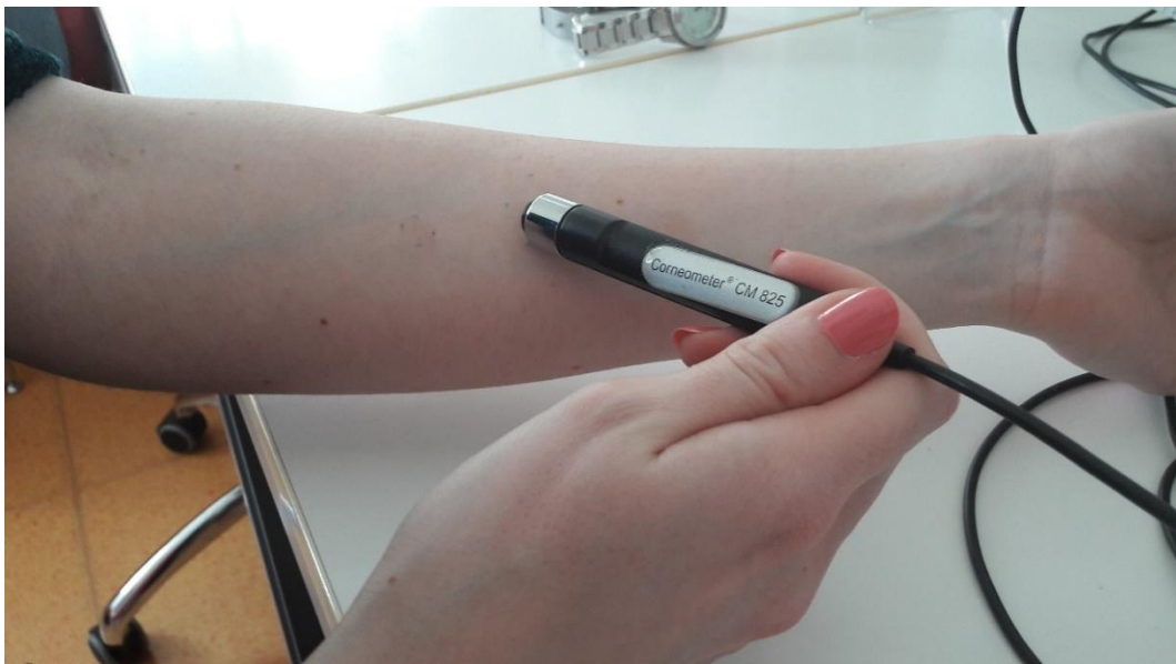
Slika 7. Mjerenje vlažnosti kože korištenjem Corneometer CM825 sonde
