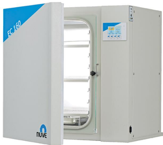
Slika 22. Vlažni inkubator za uzgoj stanica (Preuzeto s: http://www.nuve.com.tr/ )
