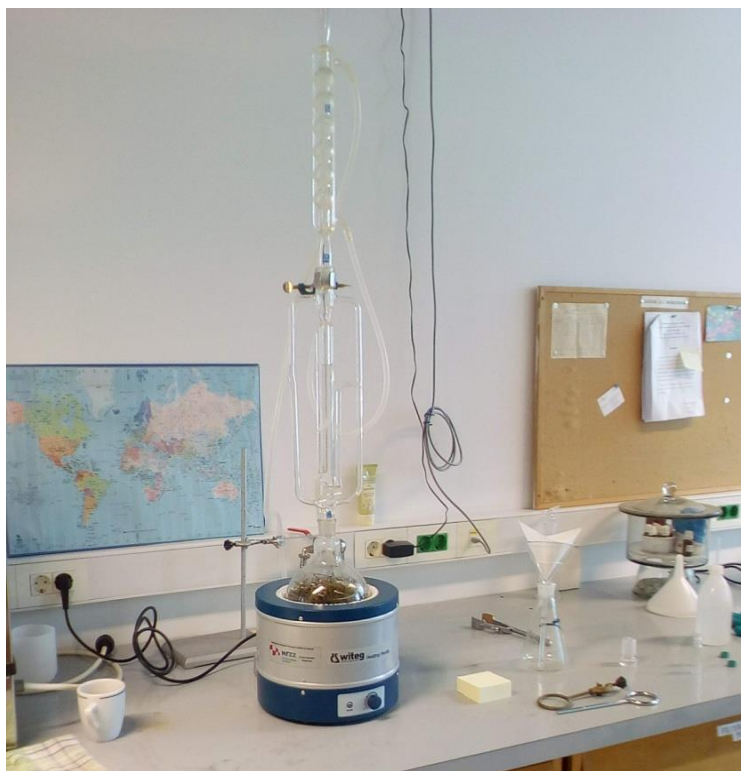
Slika 11. Hidrodestilacija uzorka, aparatura po Clevengeru
